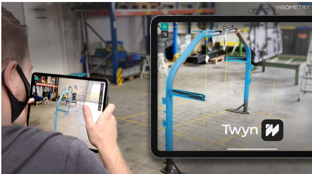
Produkt-Bild von Twyn: Augmented Reality überlagert den Digital Zwilling auf das Bauteil zum Soll/Ist-Abgleich für die Qualitätssicherung im Wareneingang.
